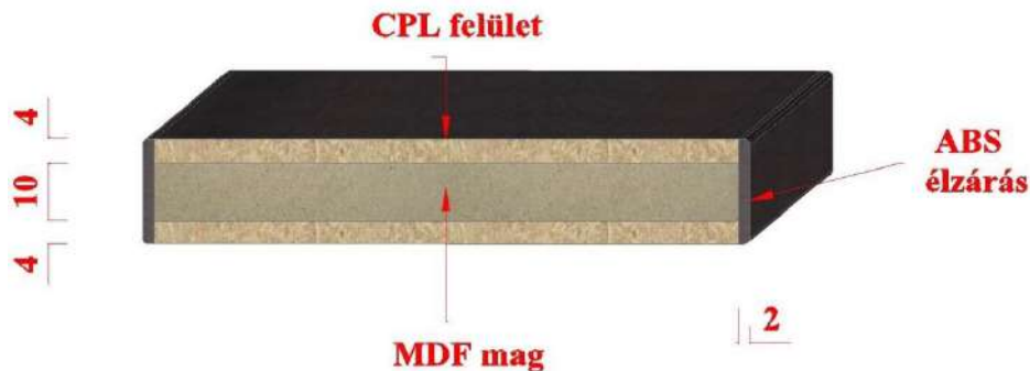
Színazonos CPL küszöb szerkezeti felépítése
